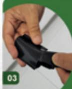
Abra o pedaço cortado e encaixe no final da mangueira Santeno dobrada.
