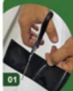
Corte um pedaço de aproximadamente 7 centímetros no final da mangueira Santeno e separe.
